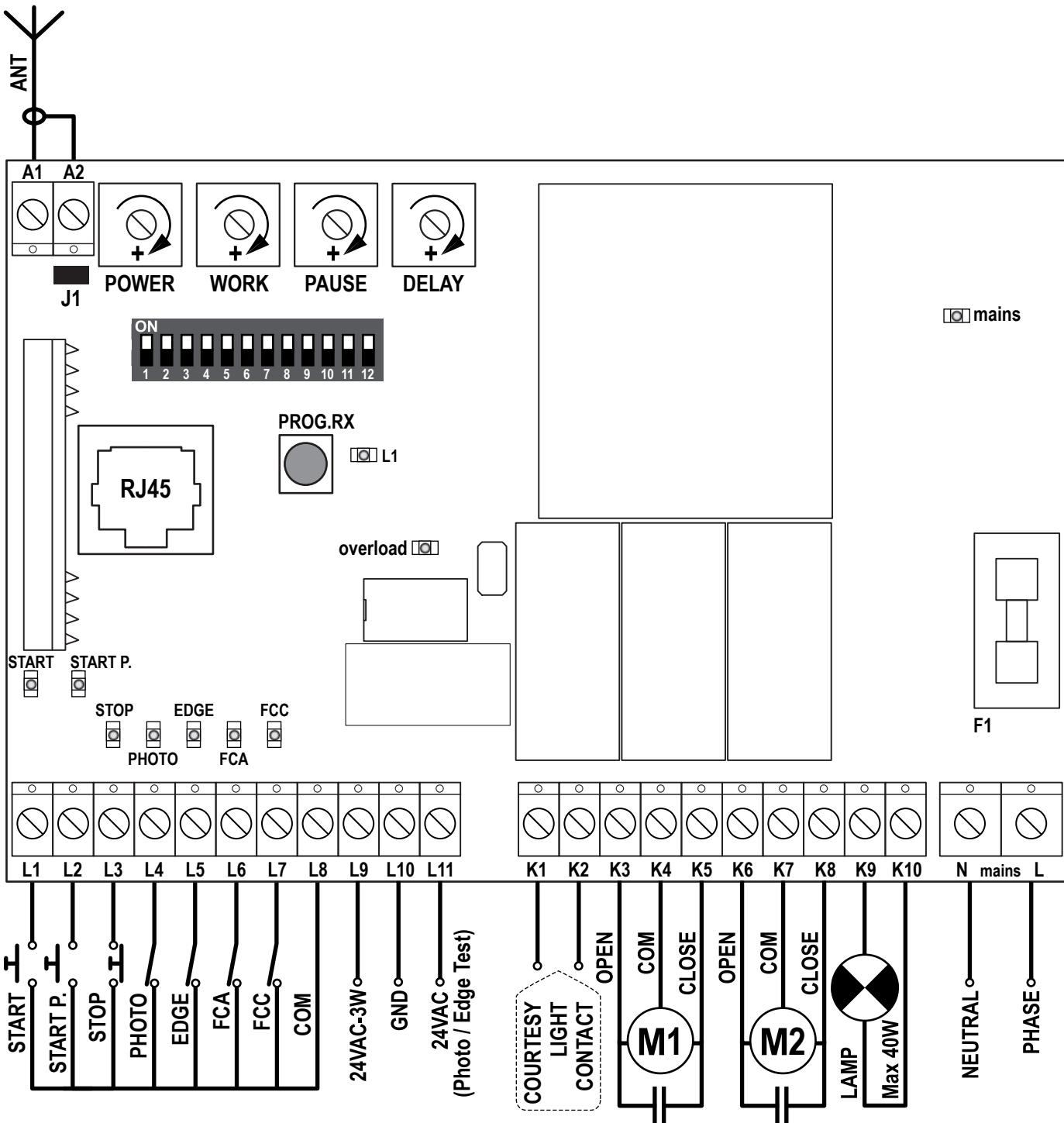
**ATTENTION:** Les entrées normalement fermées (STOP, PHOTO, EDGE, FCA, FCC) si non utilisées doivent être shuntées avec le commun commandes COM (-)
