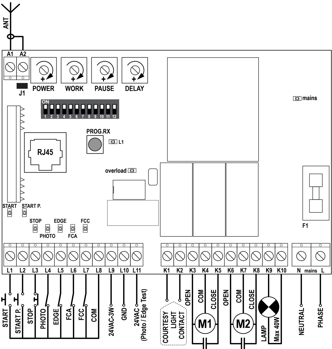
**ACHTUNG:** Die normal geschlossenen Eingänge (STOP, PHOTO, EDGE, FCA, FCC) müssen bei Nichtverwendung mit dem Hauptleiter Befehle COM (-) überbrückt werden.
