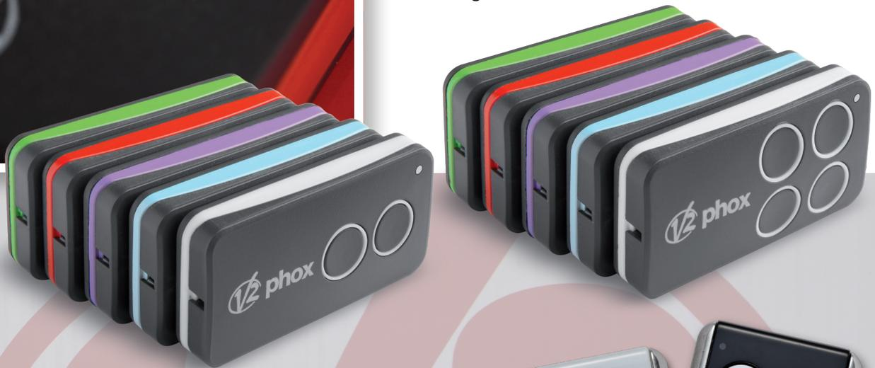
Bei den Sendern 433,92 MHz der Serie MATCH (Kopierer von festen Code) funktioniert jede Drucktaste auf unabhängige Art. **Somit ist es auf nur einem MATCH möglich, den Code von vier verschiedenen Sendern zu speichern!**
