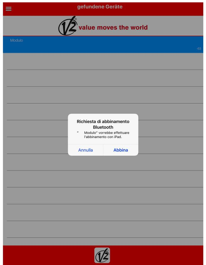
Mit einem Klick auf "VERKNÜPFEN" verbindet V2AppTool das Gerät mit Ihrem iOS Smartphone und erkennt automatisch die Art der Steuereinheit.
