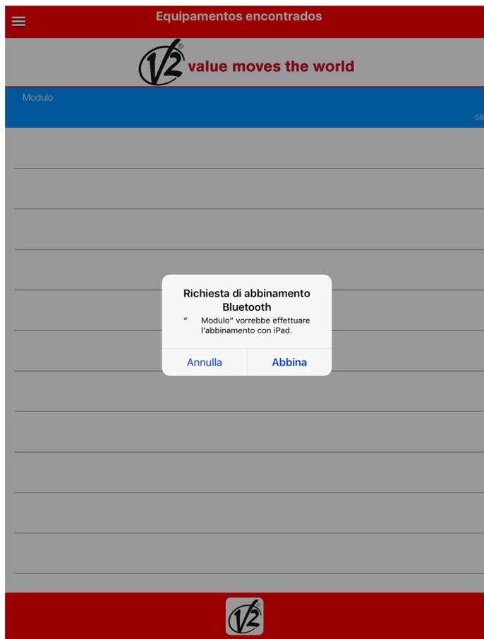
Ao clicar em “PAIR” (emparelhar), o V2App Tool emparelha o dispositivo com o seu telemóvel inteligente iOS e automaticamente reconhece o tipo da unidade de controlo.
