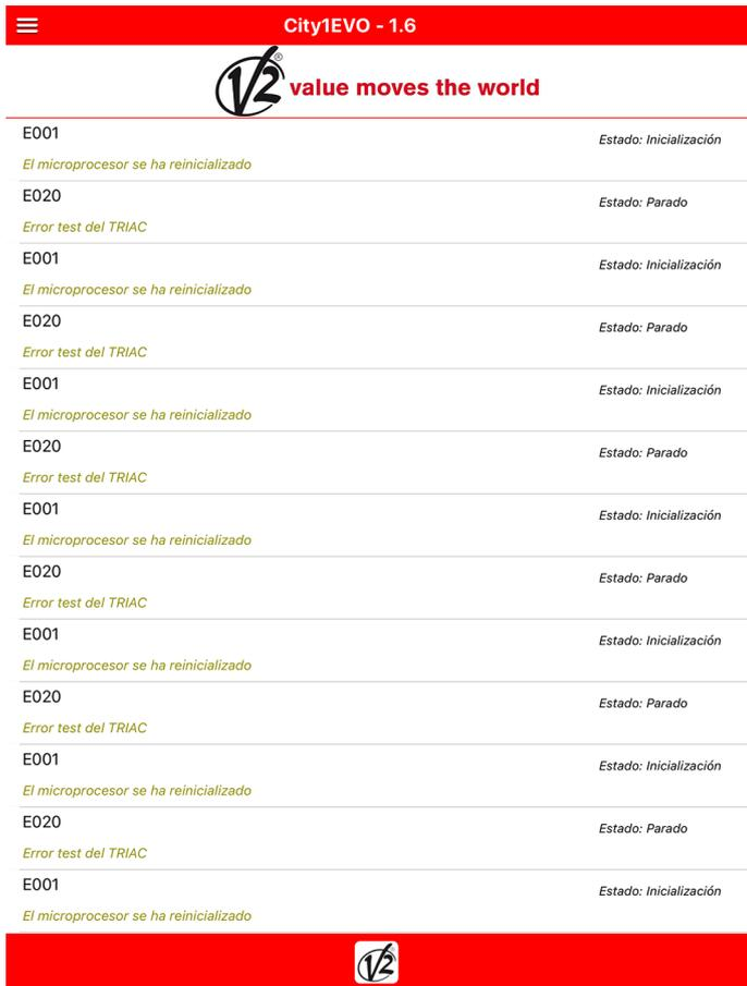
Seleccione el comando (☰) en la parte superior izquierda de la vista principal para cambiar el idioma, guardar el archivo o desconectar el módulo y volver a la vista principal.
